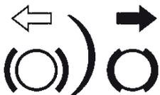
Si gira la varilla con un destornillador, siga la flecha hasta la posición "MAX, el flujo de la cadena fluye más y, si se gira a la posición "MIN", menos.
