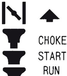
Puesta en marcha del motor. Si extrae la perilla de estrangulación (en la parte posterior derecha de la manija trasera) hasta el punto de la flecha, puede ajustar el modo de inicio de la siguiente manera:
